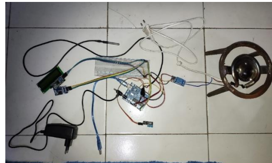
Gambar 2. Rangkaian rancang bangun alat fermentor kopi terkendali menggunakan elemen pemanas berbasis Arduino uno (Sumber: Dokumentasi Pribadi).
