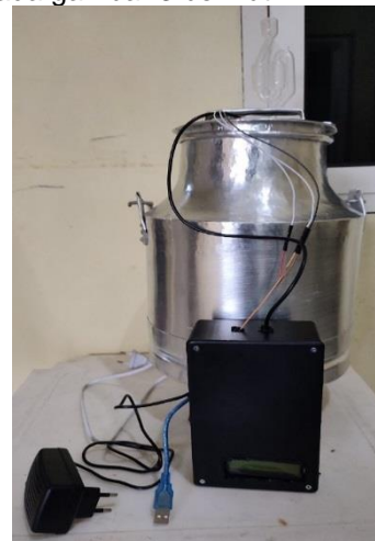
Gambar 3. Rancang bangun alat fermentor kopi terkendali menggunakan elemen pemanas berbasis Arduino uno (Sumber: Dokumentasi Pribadi).
