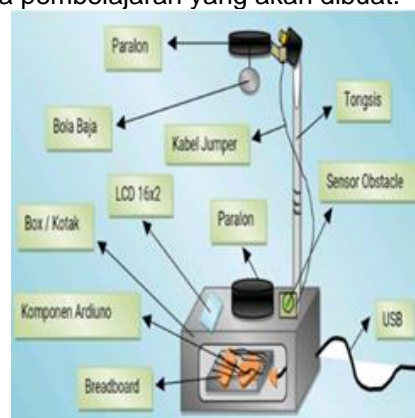
Gambar 1. Rancangan Media Alat Ukur Percepatan Gravitasi Berbasis Arduino Nano (Sumber: Dokumen Pribadi)
