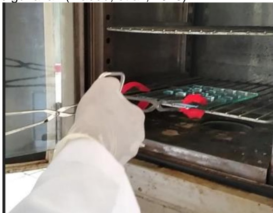
Gambar 3. Proses Pemanasan Sampel Lapisan Tipis \text{TiO}_2:(\text{F}+\text{In})
