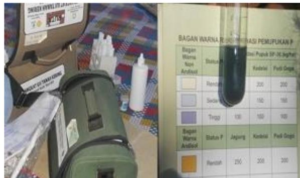
**Gambar 6.** Perangkat Uji Tanah Kering dan Hasil Pengujian Status Hara P
