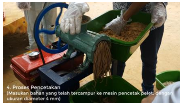
Gambar 3. Proses Pencetakan Pelet Dengan Mesin Pelet
