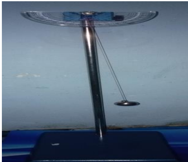
Gambar 1. Peralatan Ayunan Bandul Sederhana
